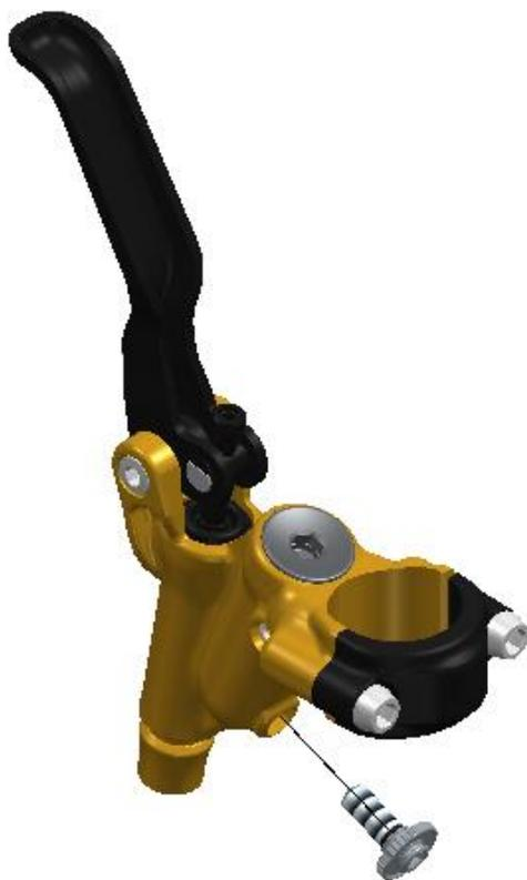
4. Svitare la vite perno leva (7 e 8). Rimuovere il parapolvere (9) e il seeger (10) in modo tale da poter rimuovere leva e perno spingi pistone.
