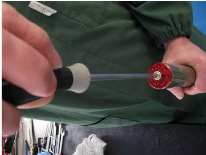
Sulla sommità della gamba di destra si trova il regolatore del freno di estensione. Girando il regolatore in senso orario, si avrà una velocità di ritorno più lenta; girandolo in senso antiorario si avrà una velocità maggiore. Generalmente, partendo dal regolatore girato tutto in senso orario, si usa una regolazione girata in senso antiorario, che va dai 16 ai 22 click, a seconda della temperatura esterna.
