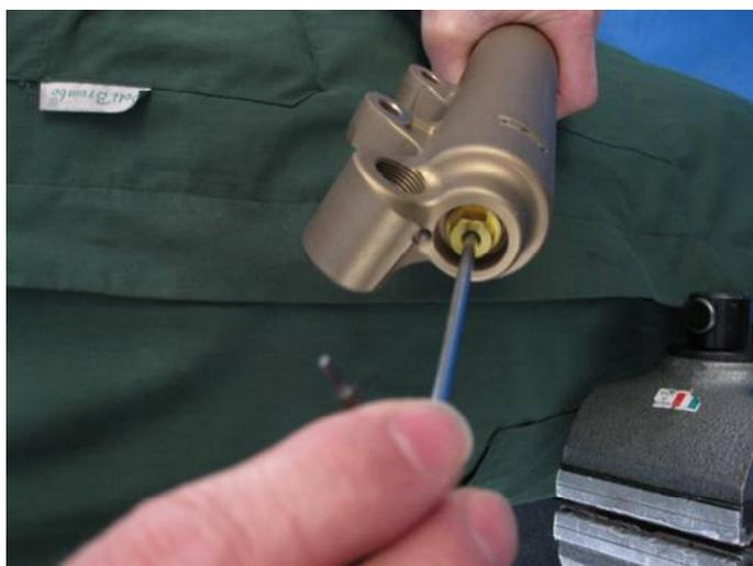
Nel tappo che si trova sotto la gamba di sinistra, si trova la regolazione di fine corsa. Questa regolazione agisce solo su gli ultimi 45mm di corsa.
