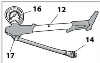
**⚠ AVVERTENZA: Non serrare eccessivamente la parte terminale (14) poiché ciò danneggerebbe la guarnizione di tenuta dello stesso.**
