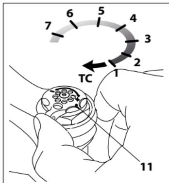
**⚠ ATTENZIONE: Non usare MAI la posizione "TC" nei tratti in discesa in quanto la sospensione idraulica non reagirà in modo appropriato all'impatto con gli ostacoli, provocando perdita di controllo della bicicletta e può causare incidenti gravi o mortali.**
