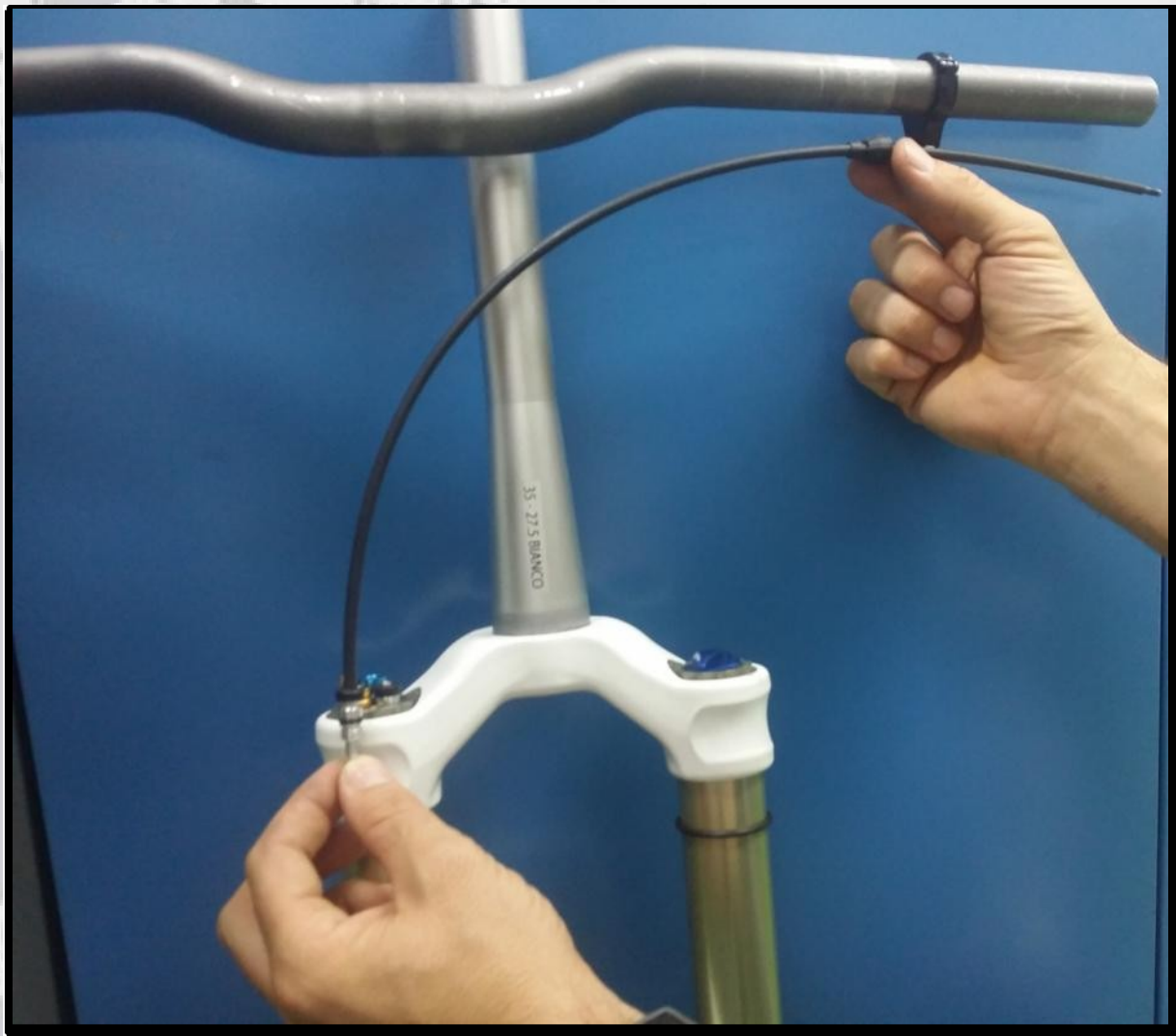
FIGURA 1: Verifica lunghezza cavo
