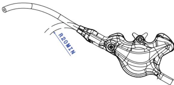
Nel caso in cui sia necessario un passaggio tubo differente con un'inclinazione superiore, si raccomanda di utilizzare il kit specifico (cod. FD50536-00). In caso di mancato rispetto di questa avvertenza, si può incorrere in danneggiamenti del tubo in prossimità del raccordo. Tali danni non sono coperti da garanzia.
