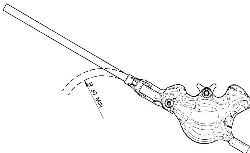
Nel caso in cui sia necessario un passaggio tubo differente con un'inclinazione superiore, si raccomanda di utilizzare il kit specifico. In caso di mancato rispetto di questa avvertenza, si può incorrere in danneggiamenti del tubo in prossimità del raccordo. Tali danni non sono coperti da garanzia.
