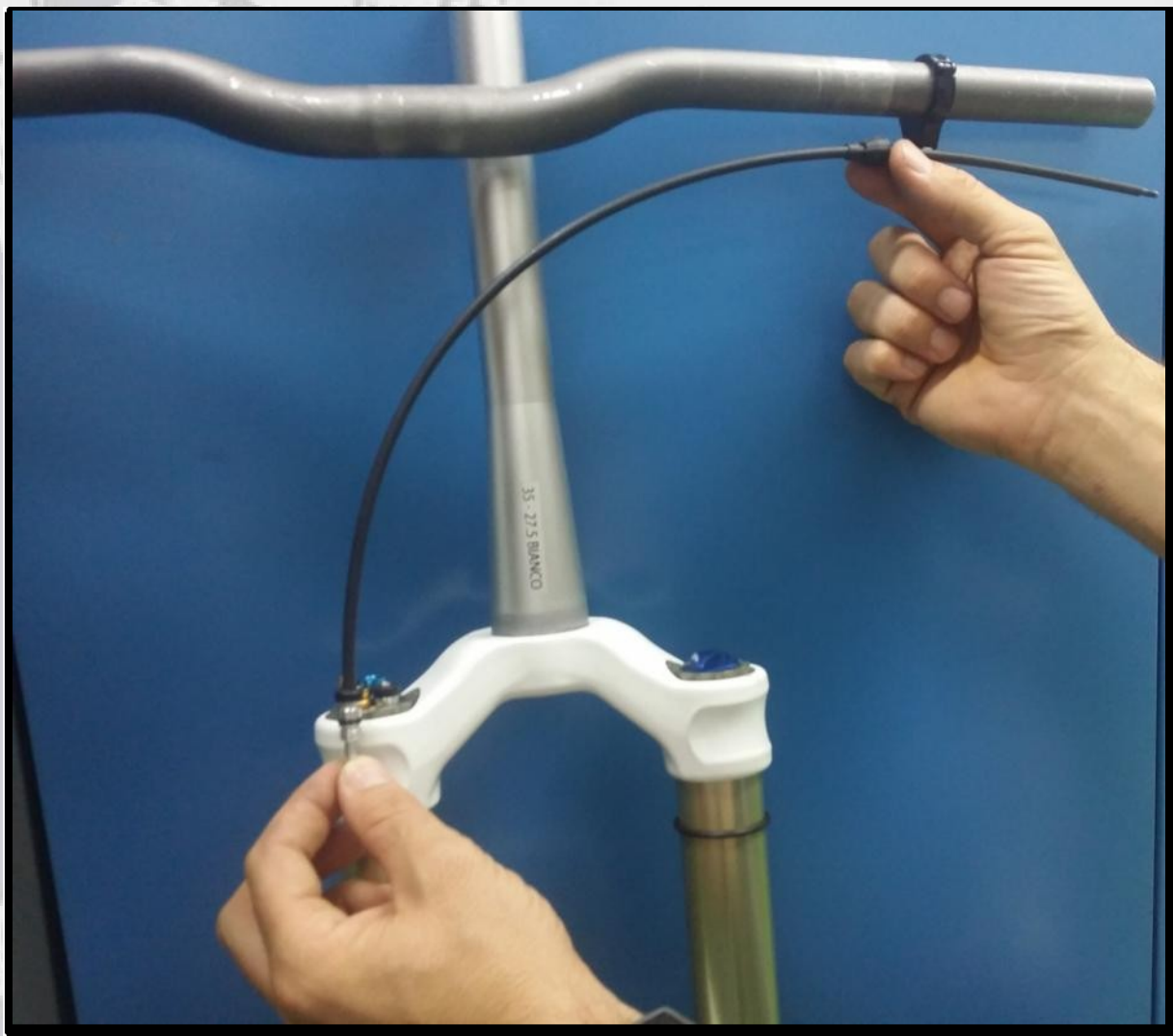
FIGURA 1: Verifica lunghezza cavo
